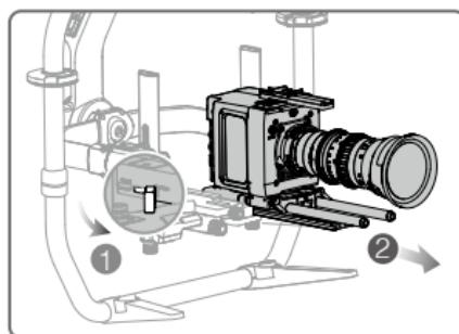
2. Разблокируйте рычаг на переходнике. Затем закрепите камеру на штативе, сдвигая ее в переходник, пока предохранительный стопор не будет активирован, а камера – сбалансирована. Затем заблокируйте рычаг, чтобы зафиксировать камеру на месте.
