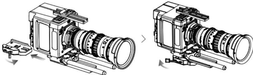
3. Zum Entfernen der Kamera vom Adapter entriegeln Sie den Hebel, und schieben Sie die Bodenplatte aus dem Adapter, während Sie die Sicherheitsverriegelung (seitlich an der Befestigungsplatte) nach unten halten.
