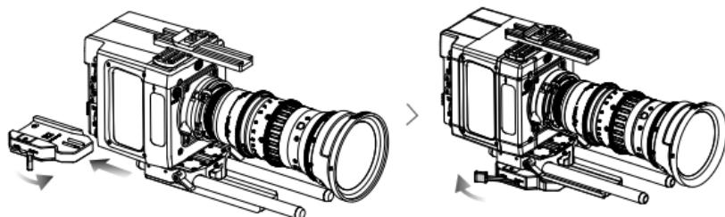
3. Para remover a câmara do adaptador, desbloqueie a alavanca e, em seguida, remova a placa de base da câmara do adaptador enquanto mantém pressionado o botão de liberação do bloqueio de segurança (situado na lateral do adaptador).
