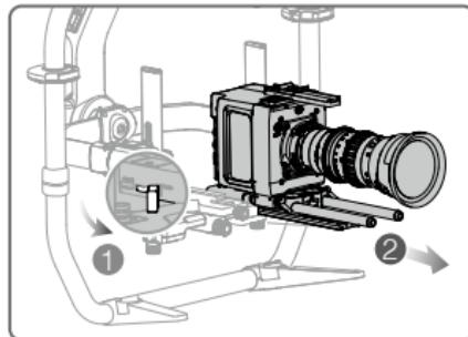
2. Entriegeln Sie den Hebel am Adapter. Befestigen Sie die Kamera anschließend am Stativ, indem Sie sie in den Adapter schieben, bis die Sicherung einrastet und die Kamera ausbalanciert ist. Verriegeln Sie dann den Hebel, um die Kamera zu sichern.
