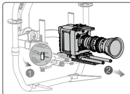
2. Déverrouillez le levier de l'adaptateur. Fixez ensuite la caméra sur le trépied en la faisant glisser dans l'adaptateur jusqu'à ce que le cran de sécurité soit enclenché et que la caméra soit en équilibre. Verrouillez ensuite le levier pour maintenir l'appareil photo en place.
