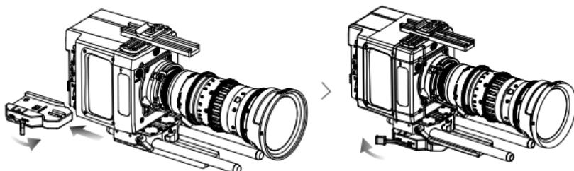
3. Para remover a câmera do adaptador, desbloqueie a alavanca e, em seguida, deslize a placa base para câmera para fora do adaptador, segurando a trava de segurança (localizada na lateral do adaptador).
