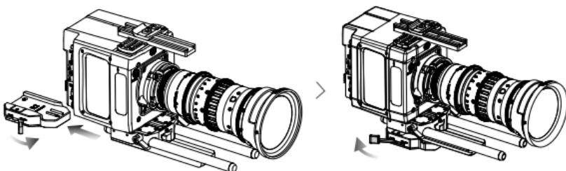
3. Om de camera uit de adapter te verwijderen, ontgrendel je de hendel en schuif je de camerabodemplaat uit de adapter terwijl je de veiligheidsontgrendeling ingedrukt houdt (bevindt zich aan de zijkant van de adapter).
