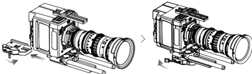
3. Pour retirer la caméra de l'adaptateur, déverrouillez le levier, puis retirez la plaque de support de la caméra de l'adaptateur tout en maintenant enfoncé le cran de sécurité (situé sur le côté de l'adaptateur).
