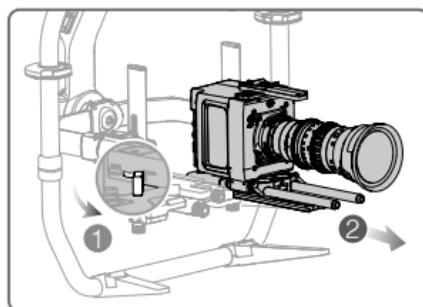
2. Desbloqueie a alavanca do adaptador. Em seguida, fixe a câmara ao tripé, inserindo a câmara no adaptador até que o bloqueio de segurança seja acionado e a câmara fique equilibrada. Por fim, bloquee a alavanca para fixar a câmara.
