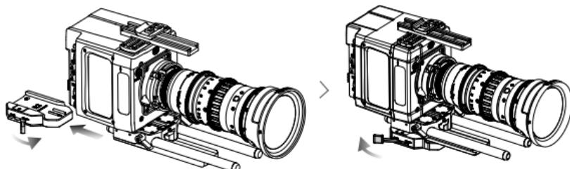
3. Per rimuovere la fotocamera dall'adattatore, sbloccare la leva, quindi fare scorrere la piastra di base della fotocamera verso l'esterno dell'adattatore tenendo premuto il gancio del dispositivo di sicurezza (situato sul lato dell'adattatore).
