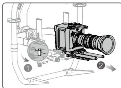
2. アダプターのレバーをロック解除します。次に、安全ロックがかかってカメラのバランスが取れるまでカメラをアダプター内にスライドさせて、カメラを三脚に固定します。次に、レバーをロックして、カメラを所定の位置に固定します。
