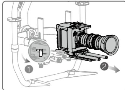
2. Desbloquee la palanca del adaptador. A continuación, fije la cámara en el trípode deslizándola sobre el adaptador hasta que el seguro quede acoplado y la cámara esté equilibrada. Entonces, bloquee la palanca para fijar la cámara en su sitio.
