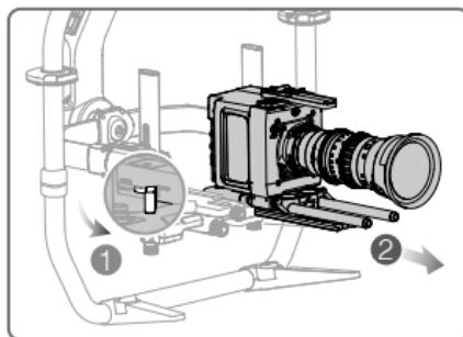
2. 打开三脚架转接件的锁扣，然后将摄影机与底部固定板一起嵌入三脚架转接件。当转接件侧边的安全锁弹起锁紧，并且使摄影机前后大致平衡后，扣紧锁扣。
