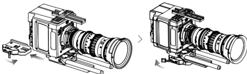
3. Чтобы снять камеру с переходника, разблокируйте рычаг и сдвиньте пластину основания камеры с переходника, нажав на рычажок разблокировки предохранительного стопора (расположен на боковой части переходника).
