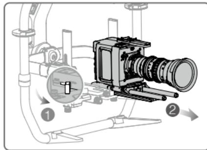
2. 打開三腳架轉接配件的鎖扣，然後將攝影機與底部固定板一起嵌入三腳架轉接配件。當底座側邊的安全鎖彈起鎖緊，請調整攝影機使其前後大致平衡，然後扣緊鎖扣。
