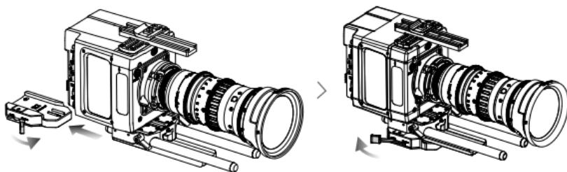
3. 如需取下底部固定板和攝影機，請鬆開鎖扣。接著請在按住安全鎖的同時，將攝影機底部固定板向外推動即可。
