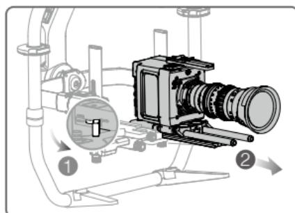
2. Ontgrendel de hendel van de adapter. Vervolgens zet je de camera op het statief door de camera in de adapter te schuiven tot de veiligheidsvergrendeling klikt en de camera is gebalanceerd. Vergrendel vervolgens de hendel om de camera op zijn plaats vast te zetten.
