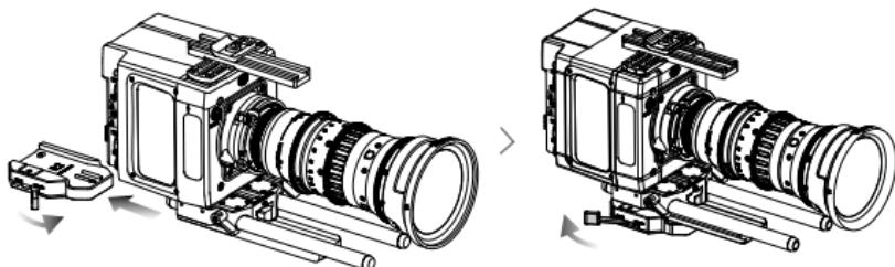
3. アダプターからカメラを取り外すには、レバーのロックを解除し、安全ロッククリース(アダプターの側面にあります)を押し下げながら、カメラのベースプレートをスライドさせてアダプターから引き出します。
