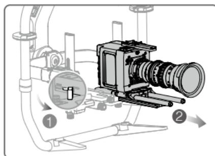
2. Destrave a alavaca no adaptador. Em seguida, fixe a câmera no tripé, deslizando a câmera no adaptador, até que a trava de segurança se encaixe e a câmera esteja balanceada. Em seguida, trave a alavanca para segurar a câmera no lugar.
