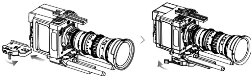
3. 如需移除底部固定板和摄影机，请松开锁扣。然后在按住安全锁的同时将摄影机底部固定板向外推动即可。
