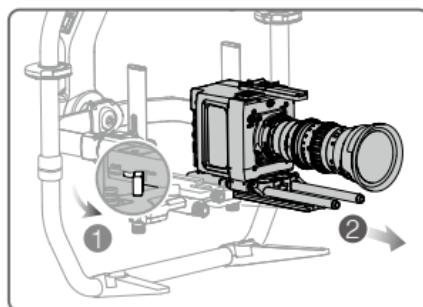
2. Sbloccare la leva sull'adattatore. Fissare la fotocamera sul treppiede facendola scorrere nell'adattatore finché il dispositivo di sicurezza non si sarà innestato e la fotocamera non sarà bilanciata. Quindi, bloccare la leva per fissare la fotocamera in posizione.
